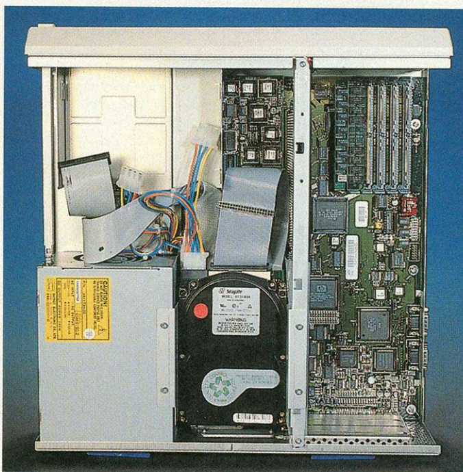
Von innen: Diese Ansicht zeigt die hohe Bauteildichte die durch die SMD-Technologie des Amiga 4000 ermöglicht wird
