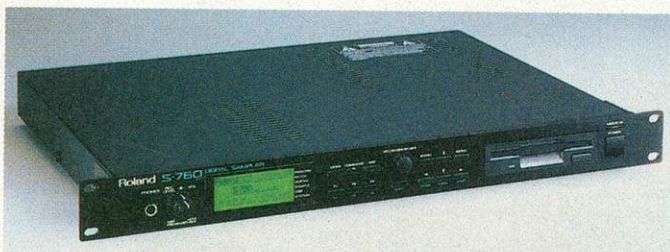
Roland S-760: Ein echter Sampler – jeder beliebige Klang läßt sich digitalisieren und umfangreich verändern
