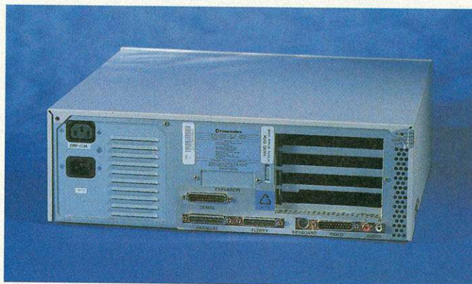
Von hinten: Der Amiga 4000 bietet eine Vielzahl von Anschlüssen, die alle Arten von Peripherien den Zugang erlaubt
